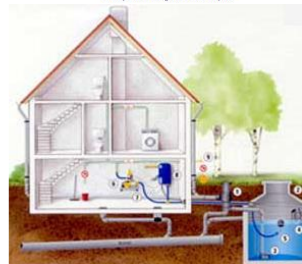
Principe du drainage des eaux de pluie
